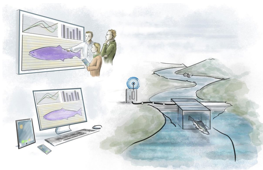
Mynd 4. Vöktun á eldislaxi með myndatökubúnaði. Skematísk mynd af Riverwatcher frá Vaka hf., sem getur tekið myndir af fiski og sent niðurstöður áfram til móttakanda.
